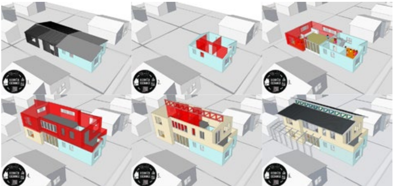
Prozess des Neubaus des Penguins Learn & Play Centers. Die aktuelle Schule ist ein einfacher Shack aus Wellblech hinter einem Wohnhaus. Der Shack wird abgerissen und die EcoBrick-Konstruktion wird auf das vorgelagerte Wohnhaus aufgesetzt. Mit einem weiteren Stockwerk wird zusätzlich Raum geschaffen.
